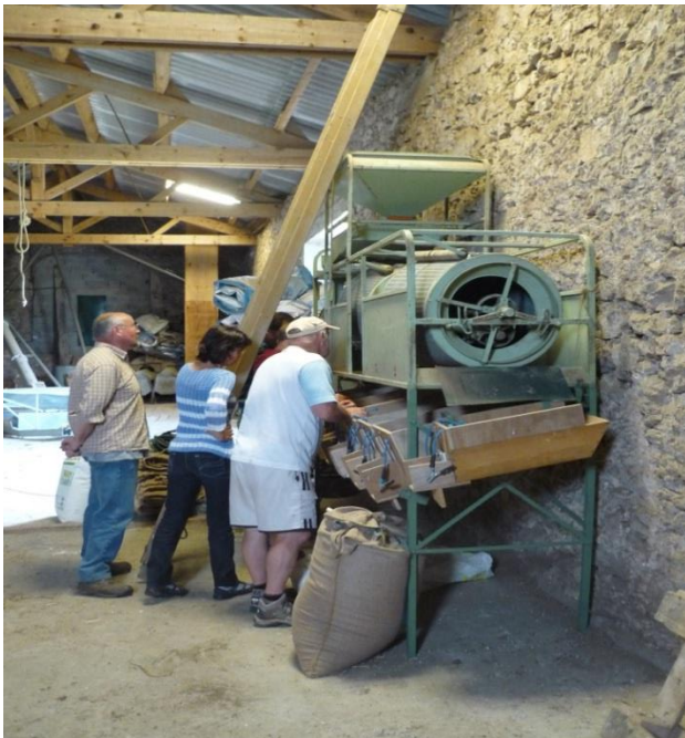
Trieur alvéolaire double cylindre de l'AVEM
